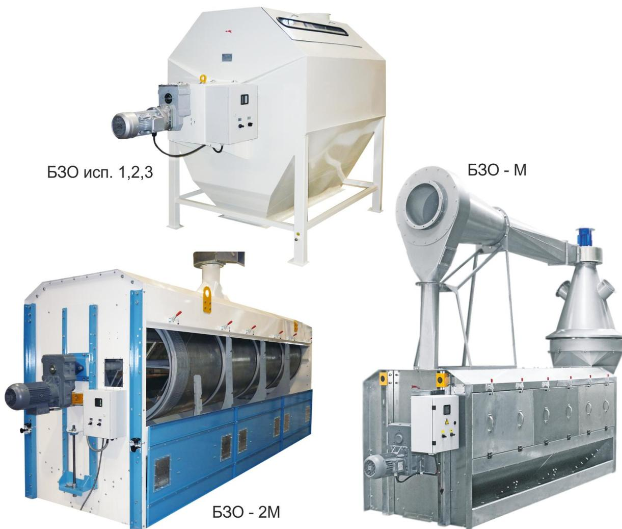
Барабанные скальператоры типа БЗО (далее по тексту «скальператор») предназначены для выделения грубых и крупных посторонних и солоmistых примесей с целью предохранения от засорения приемно-распределительных устройств последующего зерноочистительного оборудования.
